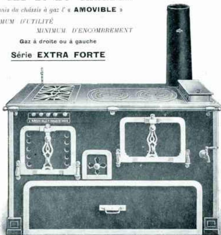
Modèle façade tôle, à pieds, 1 four à rôtir à retour de flamme, arcade avec ou sans charbonnier, 2 brûleurs à gaz (1 simple, 1 double), grilloir, rôtissoire à gaz avec rampes à **flamme bleue** et plafond récupérateur de chaleur en dalle réfractaire, gril et lèche-frite à broche, chaudière fonte émaillée, panache et couvercle cuivre, robinet, barre et supports cuivre sur la façade.
