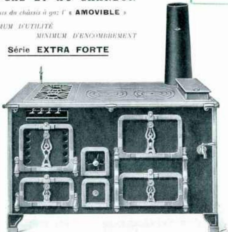
Modèle à façade tôle à pieds fonte, 1 four à rôtir à retour de flamme, 2 étuves, 2 cendriers dont un tamiseur, 2 brûleurs (1 simple, 1 double), grilloir, rôtissoire à gaz avec rampes à flamme bleue et plateau récupérateur de chaleur en dalle réfractaire, grill et lèche-frite à broche, chaudière fonte émaillée, panache et couvercle cuivre, robinet, barre et supports cuivre sur la façade.
