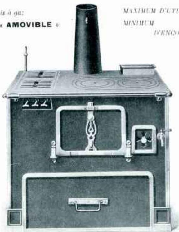
Modèle à façade tôle à arcade avec ou sans charbonnier, comprenant un grand four à rôtir sans retour de flamme, 2 brûleurs, 1 simple, 1 double à flamme bleue, sans grilloir, chaudière fonte émaillée, derrière avec panache et couvercle cuivre, robinet sur la façade, barre cuivre.
