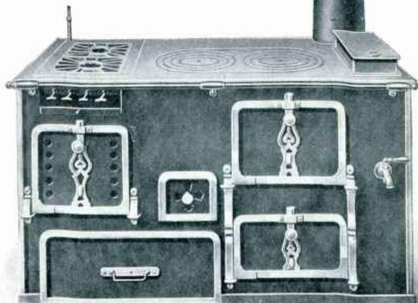
Modèle à façade tôle à ceinture et charbonnier monté sur galets. 1 grand four à retour de flamme, 1 étuve sous le four, 1 chaudière fonte émaillée, panache et couvercle cuivre et robinet sur la façade, 2 réchauds à gaz à flamme bleue (1 simple, 1 double), 1 grilloir rôtissoire à gaz avec rampes à flamme bleue et plafond récupérateur de chaleur en dalle réfractaire, gril et lèche-frite à broche, une barre cuivre sur la façade.
